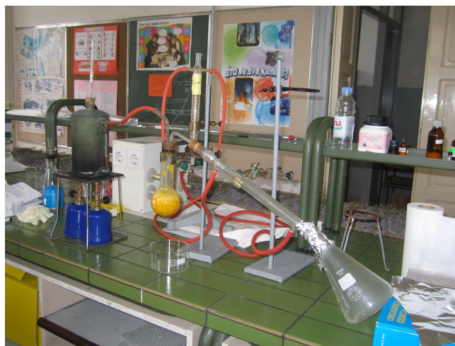
Slika 3. Aparatura za izolaciju limonena iz narančine kore
