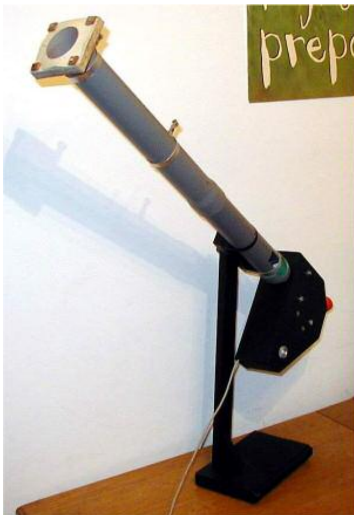
Slika 2.5. spektroskop spojen na teleskop
