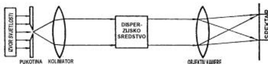
Slika 1.8 shema optičkog spektrografa
